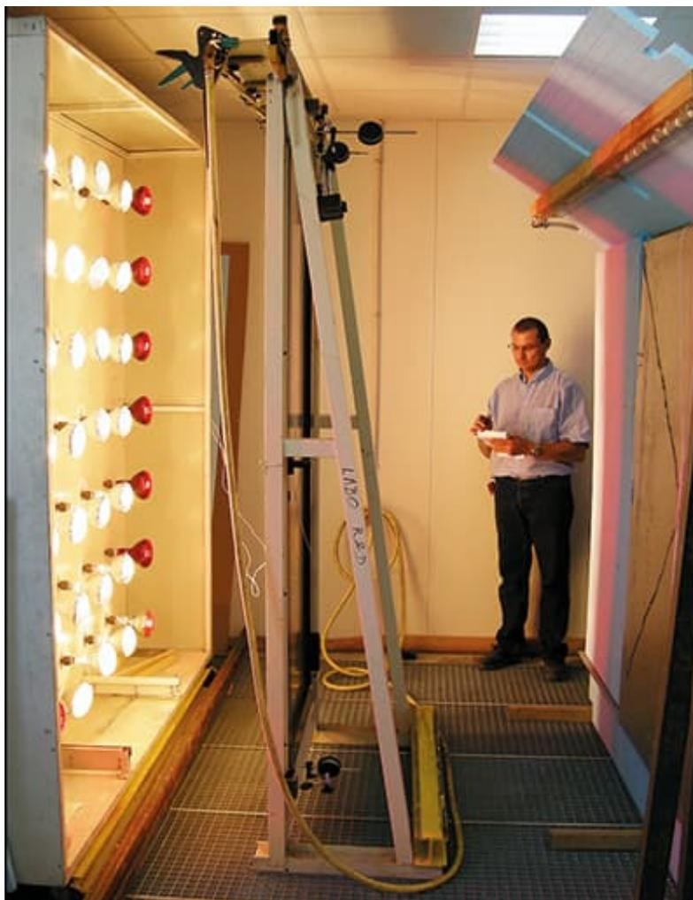
© **Isosta** - Chez **Isosta**, un technicien réalise un essai de rayonnement solaire sur un panneau sandwich sur le banc d'essai Choc Thermique Chaud
