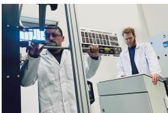
© Euradif - Euradif labo banc ensoleillement porte d'entrée Carpe Diem : menés par Euradif sur ses portes d'entrée, les essais de perméabilité à l'air, de l'étanchéité à l'eau et de la résistance au vent (AEV) permettent d'améliorer les performances des produits face aux agressions extérieures
