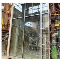
© VD-Industry - Mise en place par VD-Industry d'un essai feu sur un mur-rideau EI60 en acier de 1,65 m de largeur et d'une hauteur de 3,95 m. Équipé de capteurs, il va être incendié dans un four à brûleurs et devra faire barrage aux très hautes températures
