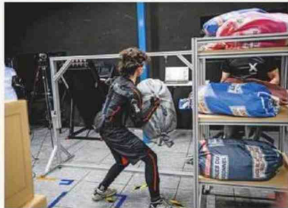
Une fois l'exosquelette ajusté, il attrape des sacs de linge de 20 kg.
