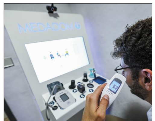
Tensiomètre, thermomètre, otoscope : la borne dispose de plusieurs outils permettant de poser un diagnostic.
